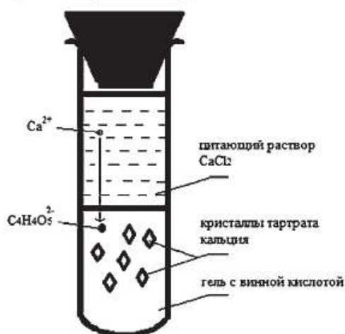
Рис. 1. Схема выращивания кристаллов тартрата кальция в геле в I-образной вертикальной трубке (пробирке)
